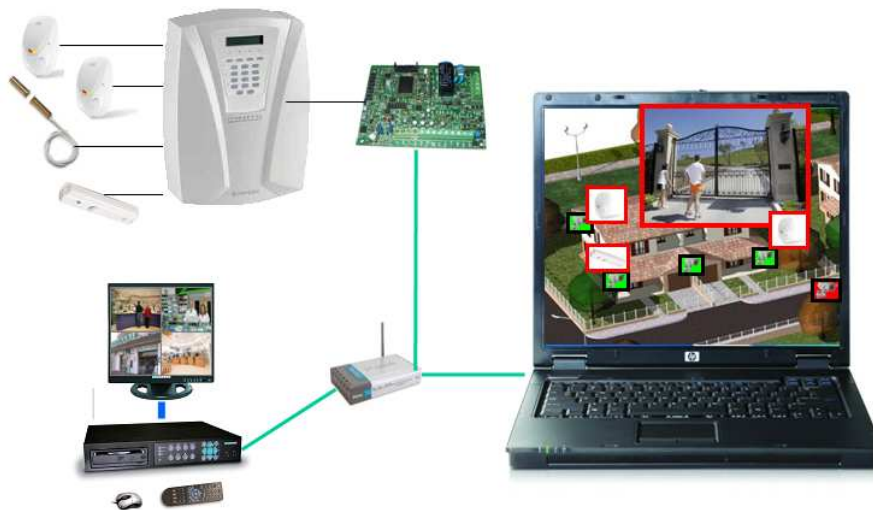
Schema di collegamento di centrali Defender con DVR Fracarro per una gestione integrata.
